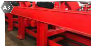
Emelt sínek automatikus hulladék eltávolító rendszerrel.
