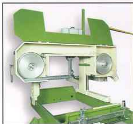
Timber Queen S bâti avec capot ouvert Timber Queen S headrig with open door
