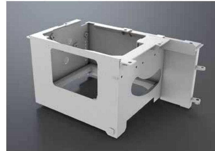
Eine solide Basis ist die Grundlage des Erfolgs. Das gilt umso mehr für die Kernkomponenten Schiebeschlitten und Sägeaggregat. Beide benötigen ein solides Fundament - den Maschinenständer.
