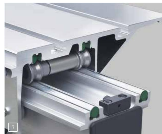
1 Der Doppelrollwagen nimmt den Querschlitten auf. Die werkseitig präzise eingestellte Parallelität zum Sägeblatt garantiert exakte Winkelschnitte über viele Jahre.
