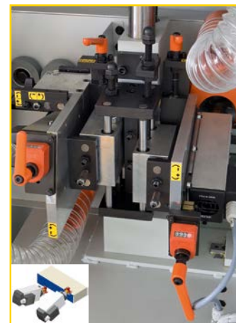
Grupo refillatore HF 12.000 g/1' inclinato a 15°
