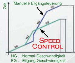
Das serienmäßige SPEED CONTROL regelt druckabhängig das Umschalten von Eilgang auf Normalgeschwindigkeit. Die Spaltleistung erhöht sich dadurch bis zu 30 % da immer mit der maximalen Geschwindigkeit gearbeitet wird.
