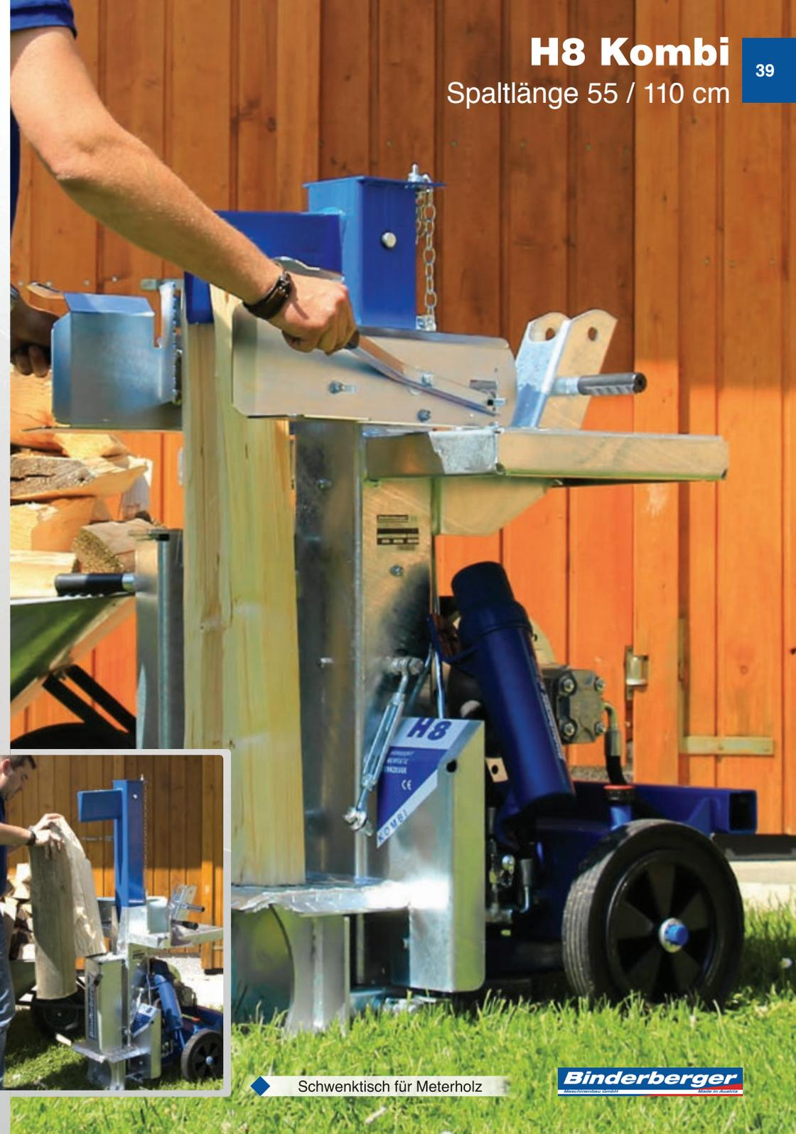
Als Antriebsvarianten stehen Spalter mit Elektromotor, Zapfwellenpumpe, Schlepperhydraulik, Kombinationsantriebe und Benzinmotor zur Wahl. Die stufenlose Höheneinstellung mittels Kette ermöglicht eine einfache und schnelle Veränderung der erforderlichen Spalllänge.
