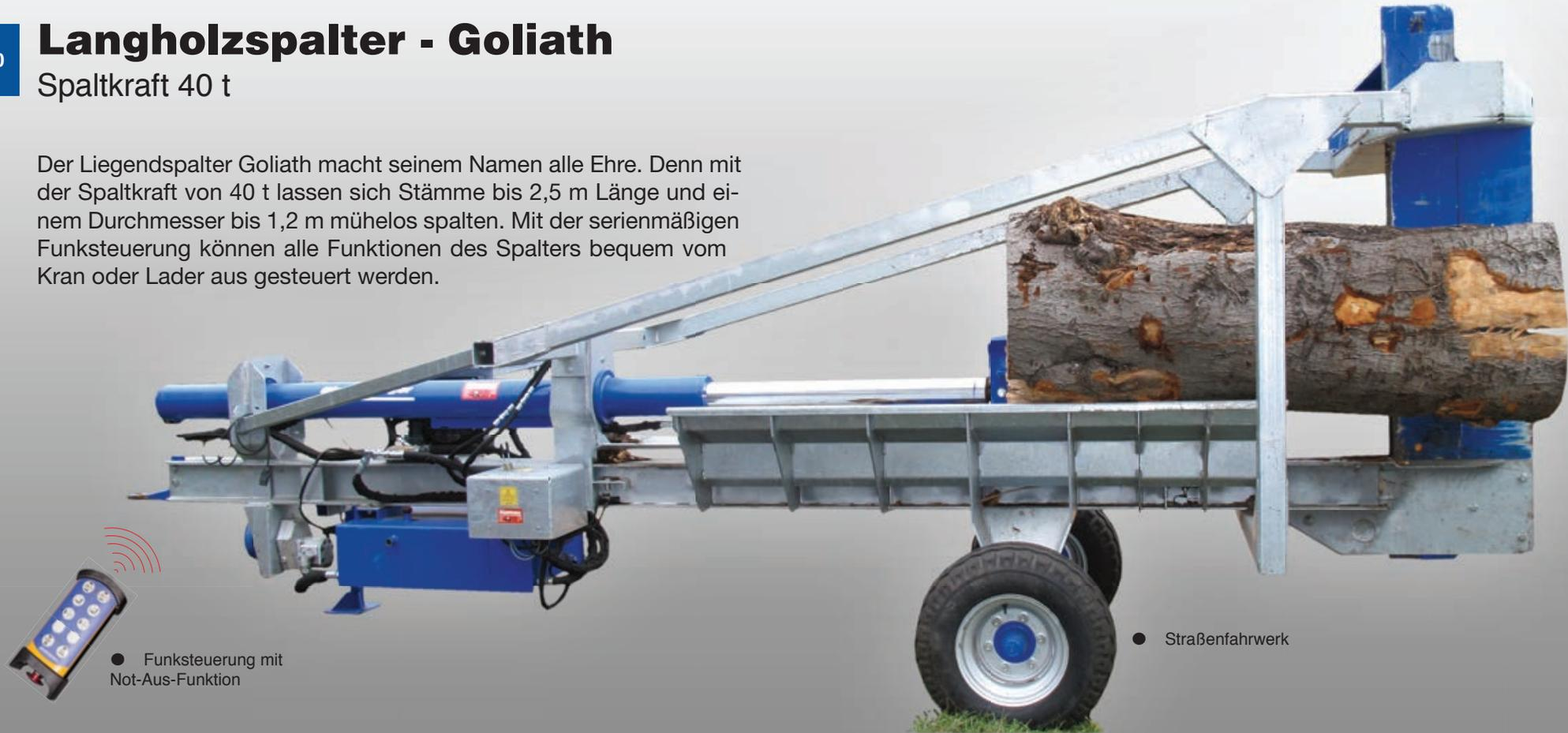
● Funksteuerung mit Not-Aus-Funktion
