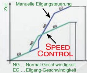
Das serienmäßige SPEED CONTROL regelt druckabhängig das Umschalten von Eilgang auf Normalgeschwindigkeit. Die Spaltleistung erhöht sich dadurch bis zu 30 % da immer mit der maximalen Geschwindigkeit gearbeitet wird.
