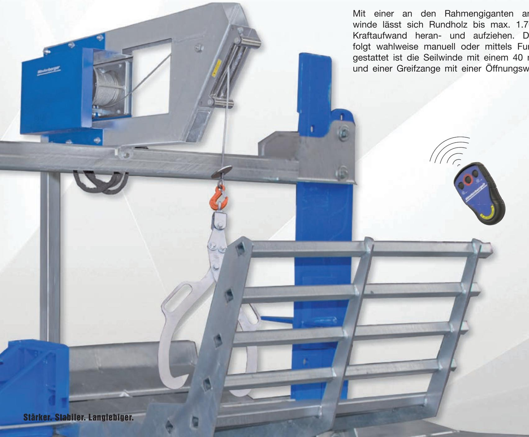
Mit einer an den Rahmengiganten angebrachten Seilwinde lässt sich Rundholz bis max. 1.700 kg ganz ohne Kraftaufwand heran- und aufziehen. Die Steuerung erfolgt wahlweise manuell oder mittels Funksteuerung. Ausgestattet ist die Seilwinde mit einem 40 m langen Stahlseil und einer Greifzange mit einer Öffnungsweite von 800 mm.
