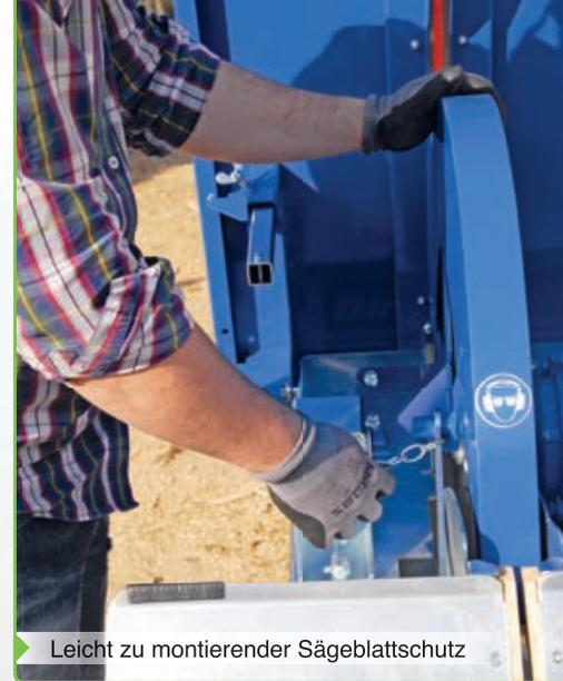
Leicht zu montierender Sägeblattschutz
