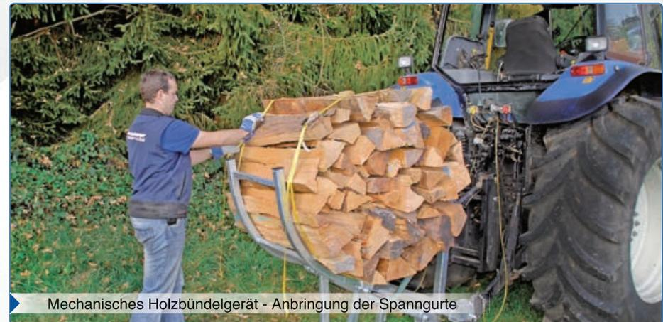
Mechanisches Holzbündelgerät - Anbringung der Spanngurte
