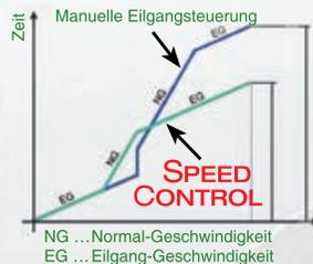
Die SP8 Modelle sind optional auch mit Speed Control erhältlich. Diese Regelung steuert druckabhängig das Umschalten von Eilgang auf Normalgeschwindigkeit. Die Spaltleistung erhöht sich dadurch bis zu 30 % da immer mit der maximalen Geschwindigkeit gearbeitet wird.
