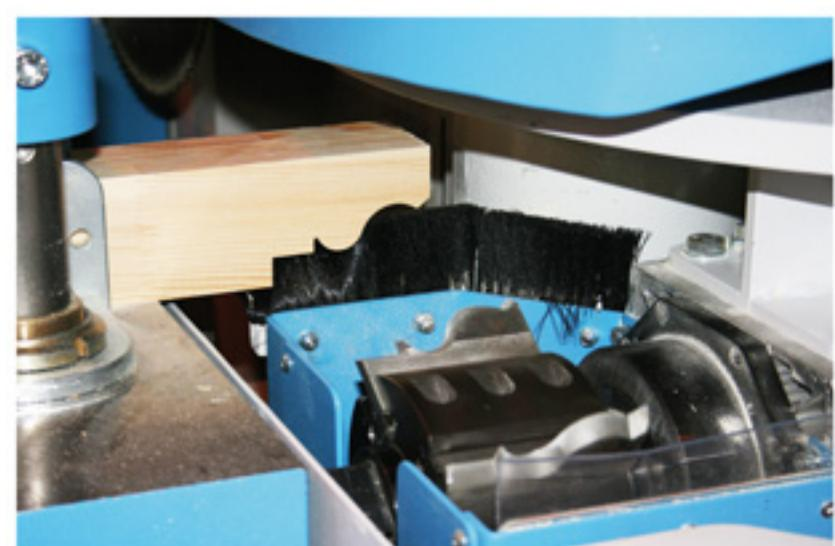
Horizontální frézovací jednotka pro konce křidel posuvných oken
