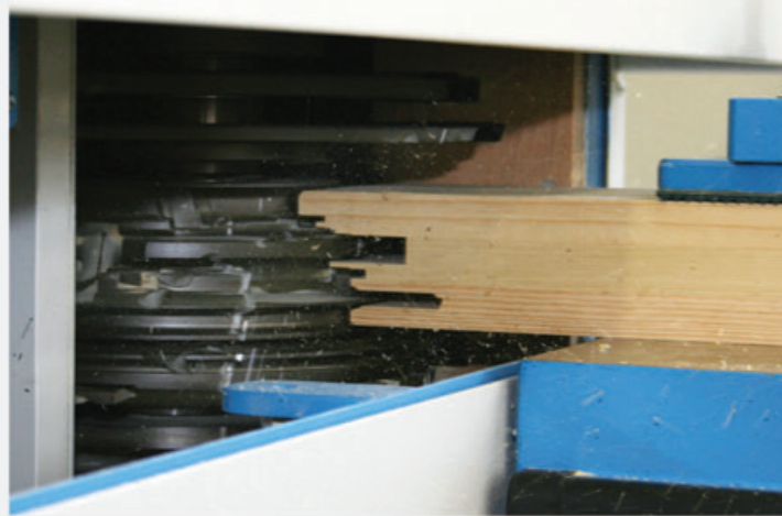
Čepovací stroj s pracovním cyklem vpřed i vzad Tenoning machine with a forwards-backwards working cycle
