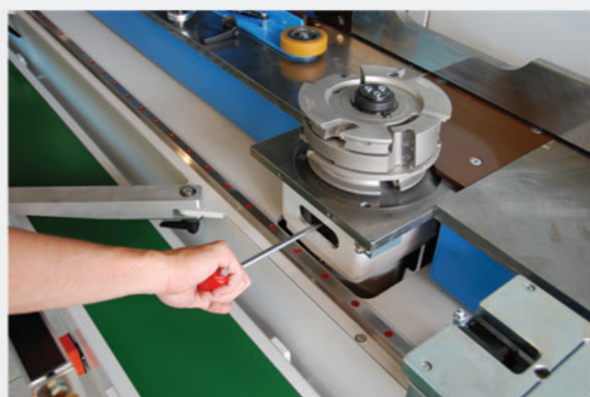
Levá pracovní profilovací jednotka Left-working profiling unit
