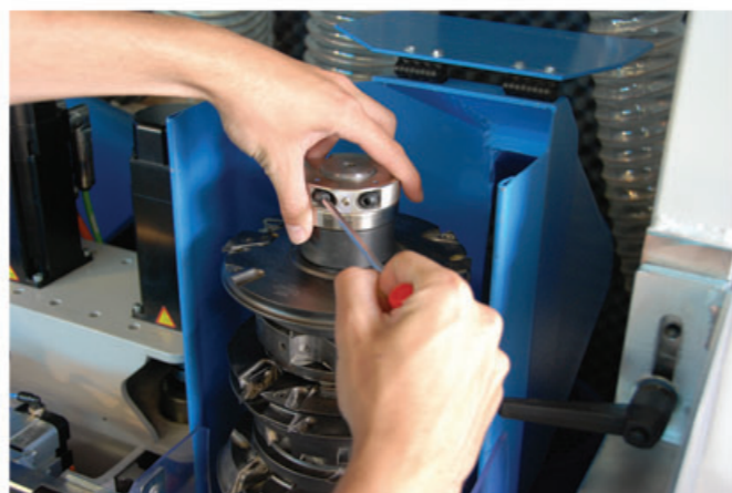
Hydro-lock upínací matice pro nástroje Hydro-lock clamping nut for tools
