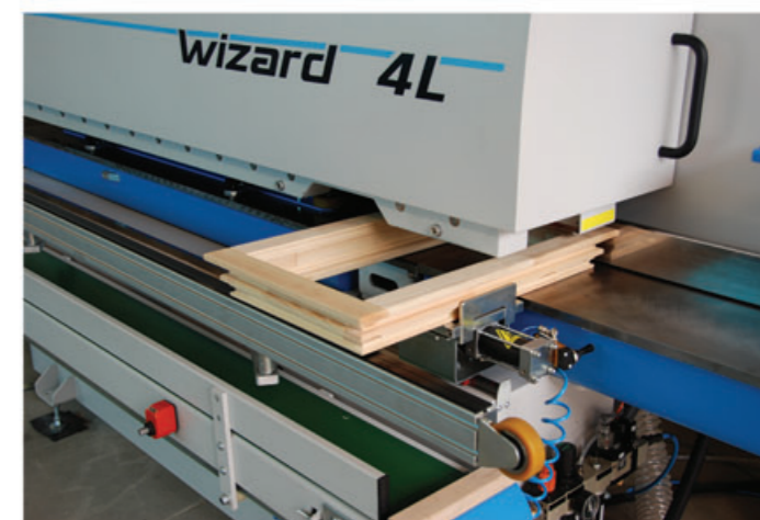
Upínací vozík pro úzká křídla Clamping carriage for narrow sashes
